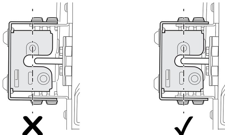
※ Verschluss & Schließblech seitlich einschieben und anheben
