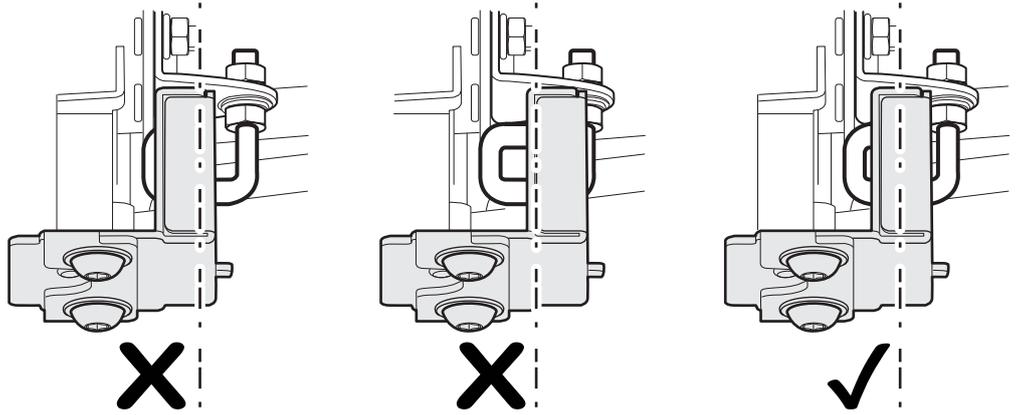
※ Verschluss & Schließblech seitlich einschieben und anheben
